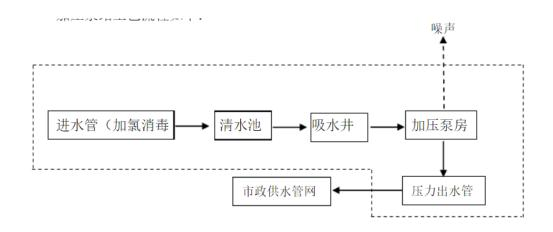
图 2.3-2 加压泵站工艺流程及产污环节
