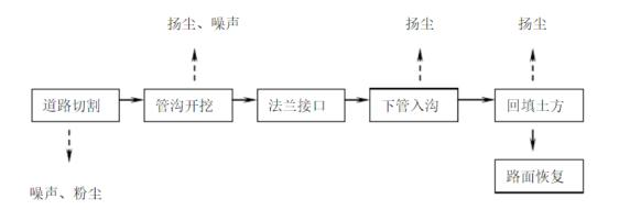
图 2.3-1 管线施工工艺流程及产污环节
