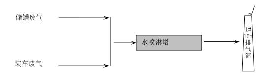
图 6.2-1 各股废气收集、分支处理流程框图
