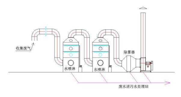
图 6.2-2 水喷淋塔工艺流程图
