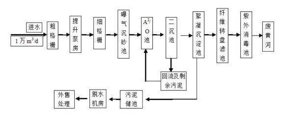
图 6.2-4 木业园区污水处理厂工艺流程图
