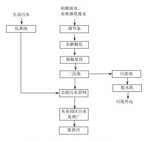
图 6.2-3 污水处理站处理工艺流程图
