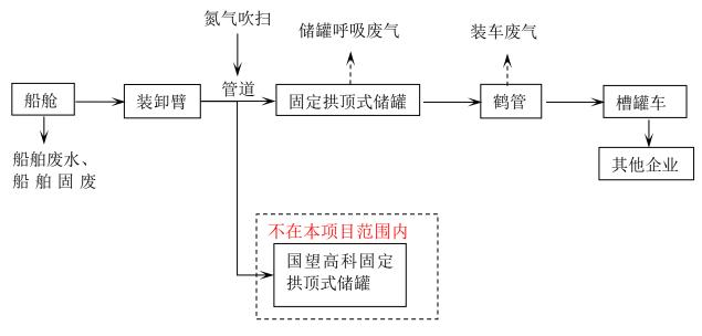
图 3.3-1 装卸工艺流程图
