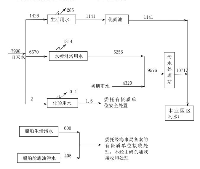
图 3.10-1 项目水平衡图 (t/a)
