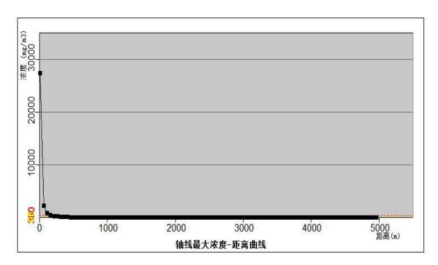
图 5.8-2 最不利气象条件下 CO 轴线最大浓度—距离曲线图
